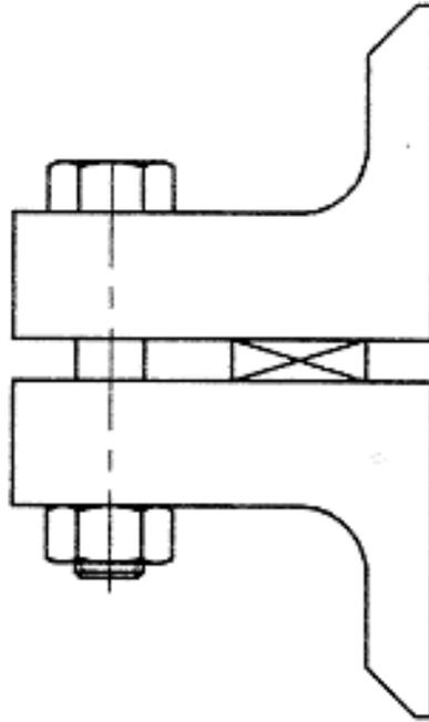
**Figure 1. Non metal-to-metal principle**
