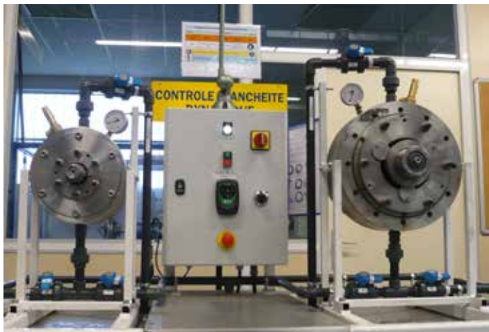
Banc d'essai pour tests d'étanchéité
